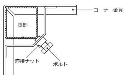
ボルトを締めすぎると、脚部の変形や溶接ナット、コーナー金具の破損につながります。十分にご注意ください。
