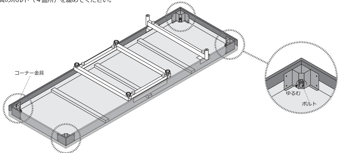
③脚部をコーナー金具に差し込みます。※奥までしっかりと差し込んでください。その後、脚部がぐらつかない程度にボルトを締め付けます。
