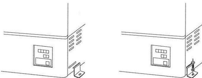
①耐震固定具(上部フック部)を本体側面下部の固定具取付孔に確実にセットします。
