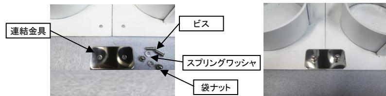
※左上写真の付属金具を右上写真の状態になるように、付属のビスを裏面から差込み、スプリングワッシャを間に挟んでから、袋ナットを締付けて連結します。
