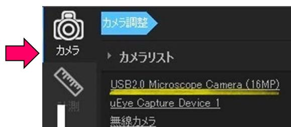
カメラのデバイス名をクリックすると、表示画面にカメラの映像が映し出されます。光量調整のため、映像表示に数秒かかる場合があります。
