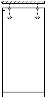
下段ユニットの天面全面を覆うユーティリティデスクは、下段ユニット側から、ユーティリティデスクに付属の木ネジ×4本を使ってねじ止めしてください。
