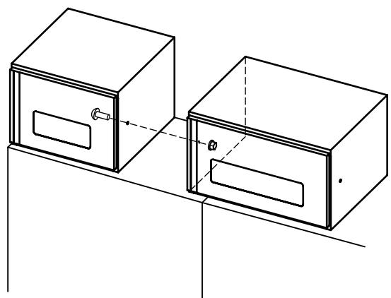
中段ユニットとの上下連結は、中段ユニット側からM6ボルト(なべ小ねじ)でねじ止めしてください。
