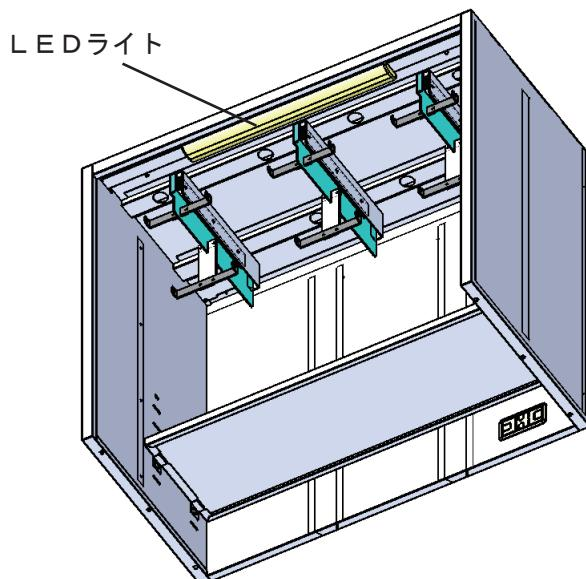
LEDライトの取り付け箇所は、点滴ユニット本体の天井の手前側です。（左図参照）
