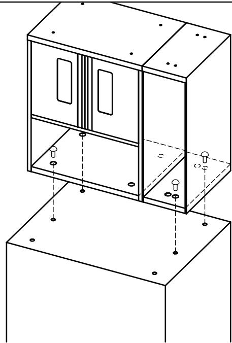
※底面用ホールプラグが付属されているユニットについては、下段ユニットとの上下連結後、露出したねじ穴を底面用ホールプラグで塞いでください。
