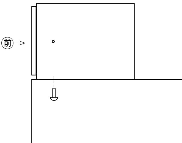
上段ユニット及び上段ダウンウォールユニットと奥行の異なるトールユニットを上下連結するには、トールユニットの前後どちらかに合わせて、トールユニット側からM6ボルト(なべ小ねじ)でねじ止めしてください。
