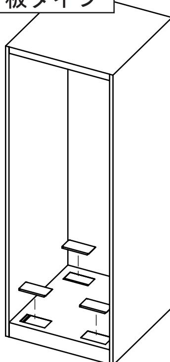
上図の全面板タイプでは、手前の2箇所のネジを外すと底板が取り外せます。
