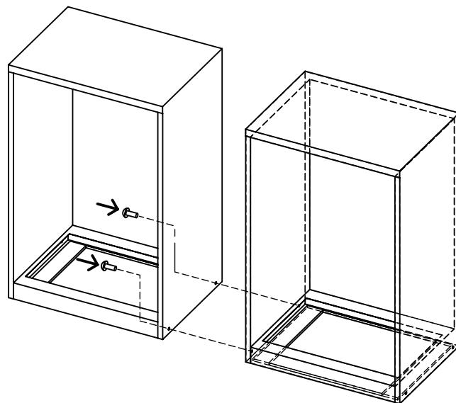
下段ユニットの横連結は、付属しているM6ボルト（なべ小ねじ）を使い、向かって左側のユニットから右側のユニットに向かってねじ止めしてください。
