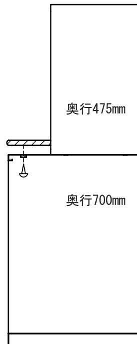
中段ユニットと下段ユニットの奥行方向にできた段差にユーティリティデスクを取り付けるには、下段ユニット側から、ユーティリティデスクに付属の木ネジ×2本を使ってねじ止めしてください。
