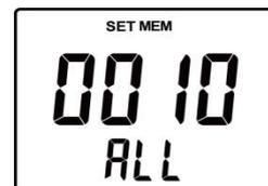
保存測定データ消去画面でセットボタンを押すと、右のような画面が表示されますが、本機種ではこの機能は使用しないため、再度セットボタンを押して次の画面に進んでください。
