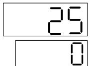
\* 測定温度表示部に表示される数値は現在の庫内温度で、設定温度には0°Cが表示されます。
