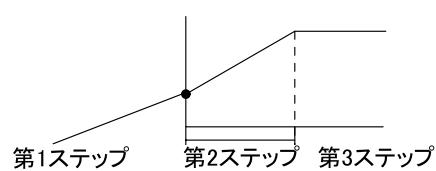
● 本製品は、設定時間が短いために目標温度まで時間内に達しない場合、次のステップに進みます。設定時間は温度上昇能力を考慮の上、設定してください。また、冷却機能はございませんので、冷却時にも設定時間にご注意ください。
