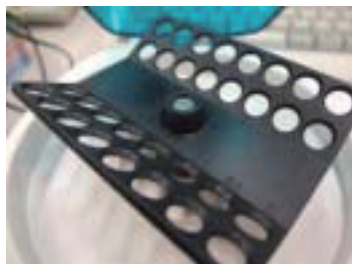
8連0.2mlチューブ用ロータをネジ止めする
