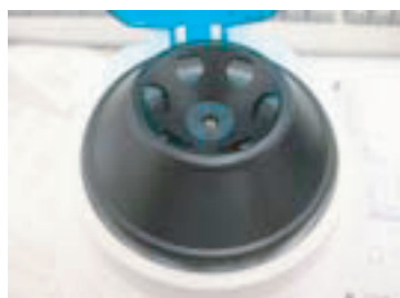
1.5/2.0ml チューブ用ロータ部のネジを外す
