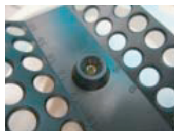
8連0.2ml チューブ用ロータを取付ける
