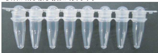
写真1. 使用可能な8連0.2ml チューブ (推奨チューブ: ビオラモPCRチューブ 品番: 1-1599-03、04)
