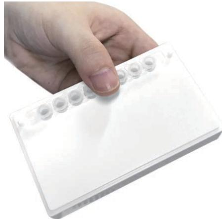
②一方の手でベースとPCRチューブを抑えながらもう一方の手でカバーを下記写真のようにPCRチューブに対してスライドさせます。
