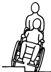
●傾斜地又は段差の所を横切の場合、基本的には段差、急坂、溝での操作説明で説明した要領で行って下さい。どうしても横切らなければならない場合、片方へ傾斜した道路などでは(車椅子が急に低い方へ向いてしまう)〈乗ってる人が低い方へ倒れるので車椅子も一緒に倒れる恐れがある〉等の点に注意して下さい。又車椅子の方向、乗ってる人の傾きを十分注意しながら行って下さい。
