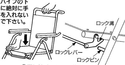
②押し拡げ、シート前下側のロックレバーの溝がロックピンに、ロックされた事を確認して下さい。
