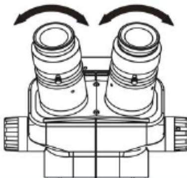
眼の幅に合うように、左図の矢印方向に、接眼レンズを調節してください。
