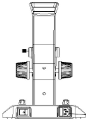
落射・透過照明輝度調節ノブを回し、明るさを調節してください。時計回りに回せば明るくなり、反時計回りに回せば暗くなります。
