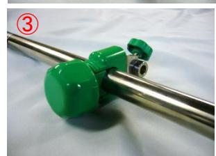
・上記写真①～③の手順で組み付け、最後に締付グリップをしっかりと締めつけてください。
