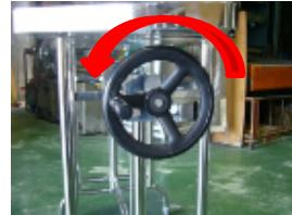
天板の下降は、昇降用ハンドルを、左写真の矢印の方向(左回転)へ回転させると、下降します。
