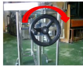
天板の上昇は、昇降用ハンドルを、左写真の矢印の方向(右回転)へ回転させると、上昇します。
