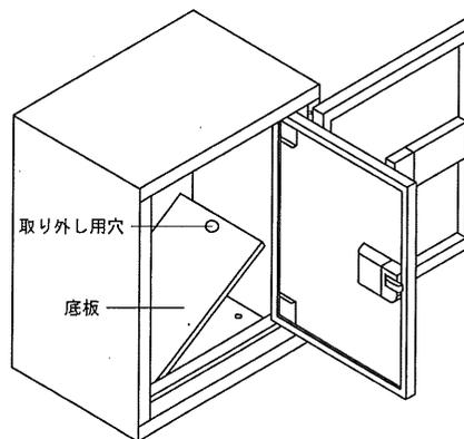
(2) 底板の穴を利用して底板を外します。
