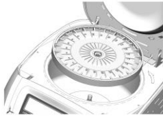
固定軸にローター を取り付け
