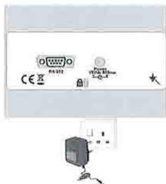
天秤後部のコネクターに電源コードを取り付け、それをコンセントに差し込みます。ディスプレイに天秤の機体番号(設定がされている場合)とソフトウェアのリビジョン番号が表示され、その後天秤の最大秤量が表示されます。
