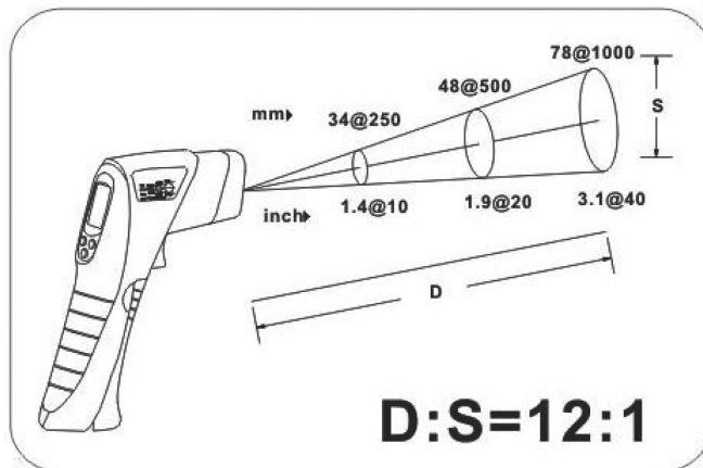
測定対象物の大きさは、図に示す照準ピッチよりも十分大きいことが必要です。測定対象物が小さけれ より近づけて測定してください。
